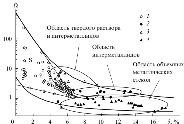
Рис. 9. Корреляция параметров \Omega и \delta для высокоэнтропийных систем. 77
